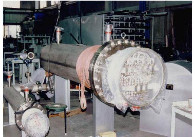
写真1 N 2 ガス加熱器
