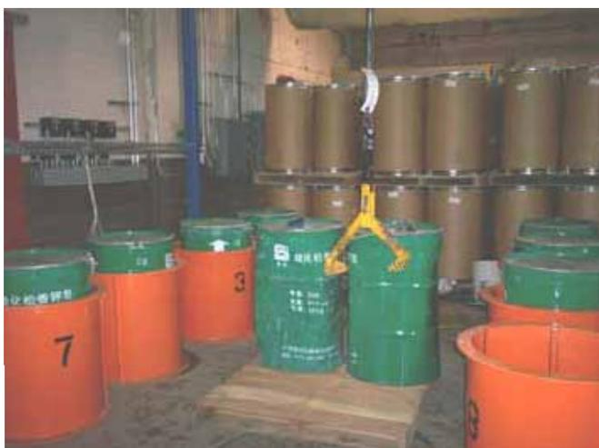
サーモセーフ”A”型誘導加熱ドラムヒーターと BF400 電力調整器を用いて非常に良好な実験結果を受けて、同社は加温槽を 8 式のこの組合せに置き換えました。通常 150° F (65°C) が融解温度のドラム缶内の石鹼を溶かすのに以前は 8-12 時間かかっており、また、しばしば全体の槽をドラム缶一つだけでも使っていました。
