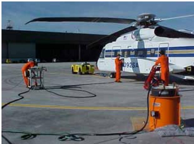
136° F の高温の JP-8 燃料の樽から燃料を供給している Sikorsky S-92 航空機のテスト機と
