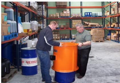
(シリコーンラバーの巻き付けヒーター等から熱を与える場合に起こりうる) 局部過熱は容易に酸化や物性を損ないますが、運転上は素早い融解を求められます。サーモセーフ誘導加熱ドラムヒーターの使用は、特に LMK 社の可変電力調整器を併用した場合は、これにかなえるのに最適です。電力供給は最適な熱吸収スピードと完璧に適合するので、例えば、無人の場所で夜間に安全に残らず融解できます。
