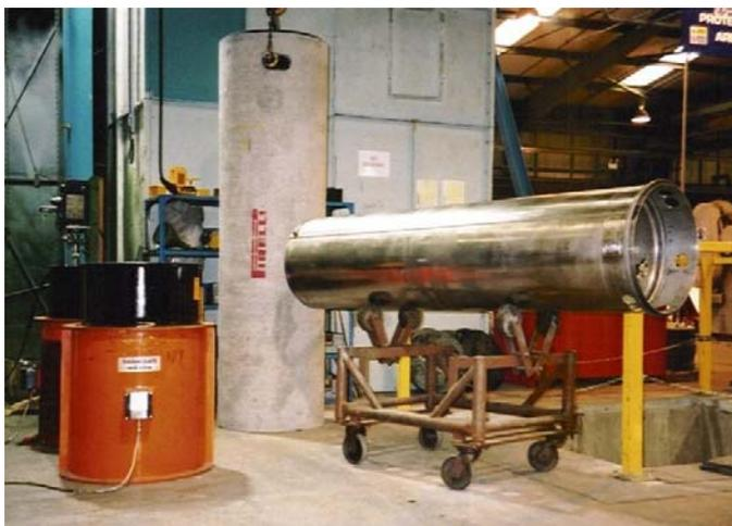
Pirelli Cable Accessoriesは400kvまでの高電圧ケーブルの配電の幅広い範囲の部品を供給しています。ケーブルに沿って地中へ埋めるため、その圧力に応じたケーブルタンク用のステンレスが要求される例があります。コンクリート容器の中にアスファルトを入れたタンクで追加的な保護をします。組み立て工程で圧力容器はコンクリート容器の中に入れ液状のアスファルトは圧力容器とコンクリート容器の間に流し込みます。
