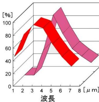
石英ヒーターのピーク波長：1.5~5.6 $\mu\text{m}$
