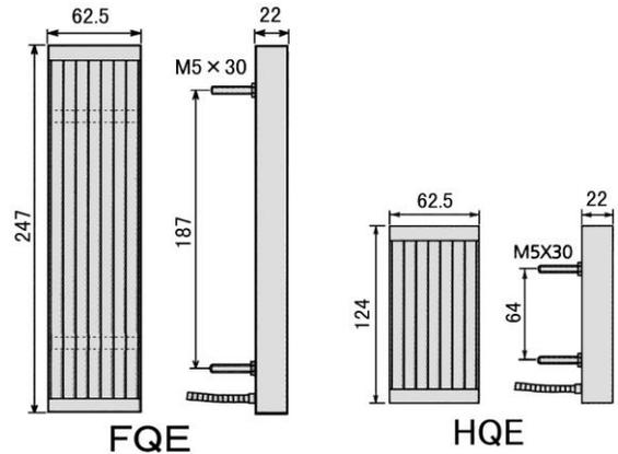
図2 石英ヒーターの形状と寸法
