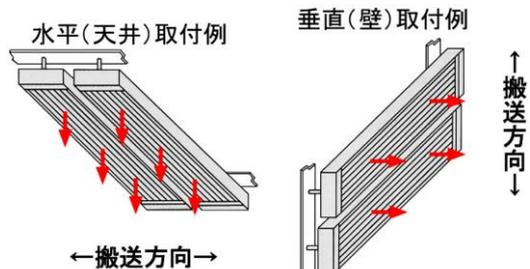
図3 石英ヒーター取り付けと搬送方向の注意
