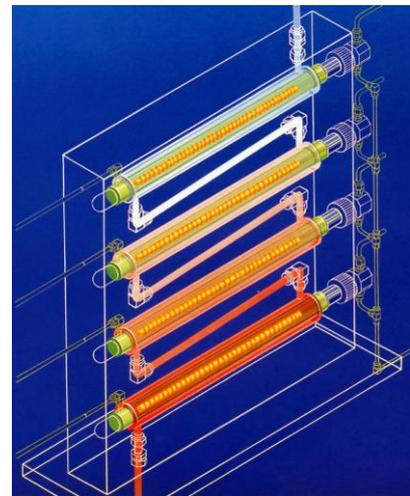
図5 透明石英二重管式熱交換器の場合
